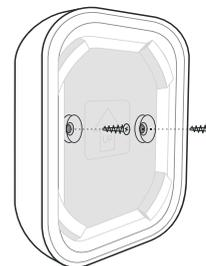
2. Наденьте сирену на панель SmartBracket и проверните по часовой стрелке, затем зафиксируйте устройство шурупом.
