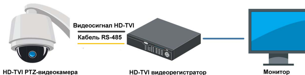
Рис. 2.3. Типичная схема управления через видеорегистратор
