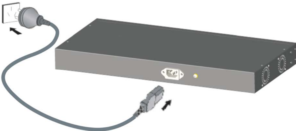
Рис. 3.7. Подключение кабеля электропитания
