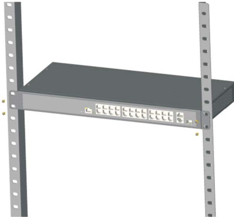
Рис. 3.3. Установка в стойку
