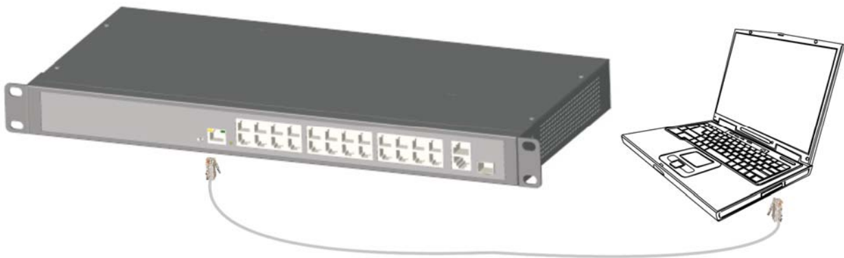
Рис. 3.6. Подключение компьютера к консольному порту
