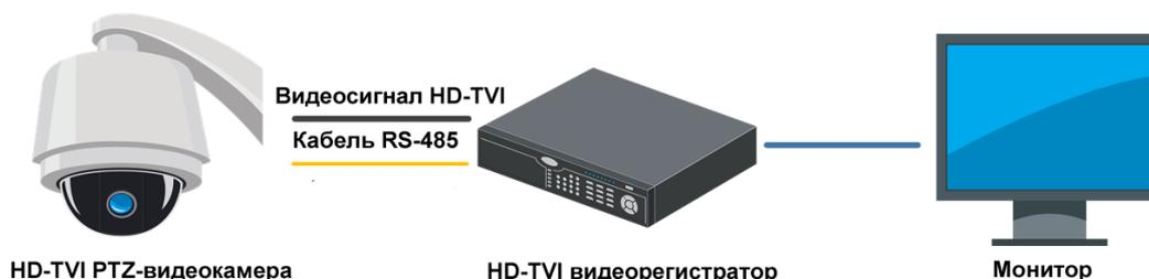
Рис. 2.3. Типичная схема управления через видеорегистратор
