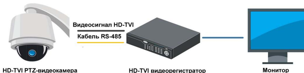
Рис. 1.9. Типичная схема управления через видеорегистратор
