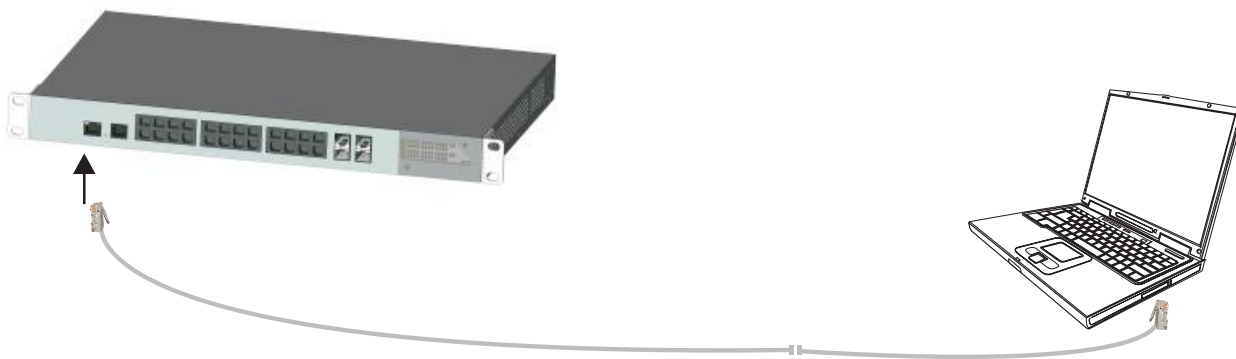
Рис. 3.5. Подключение компьютера к консольному порту
