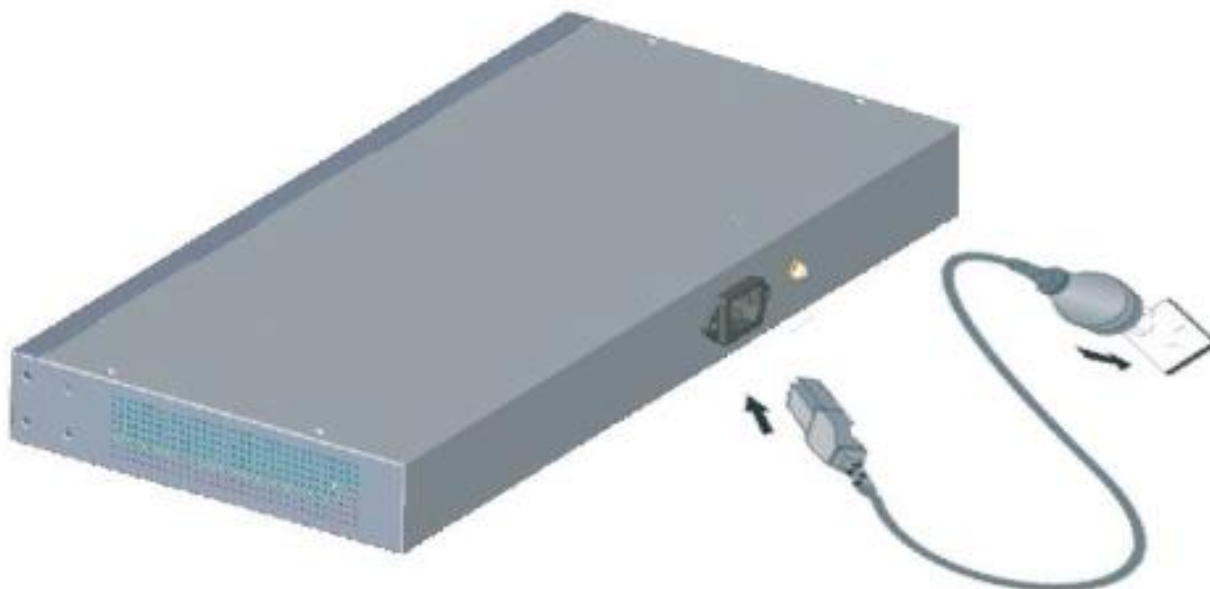
Рис. 3.6. Подключение кабеля электропитания
