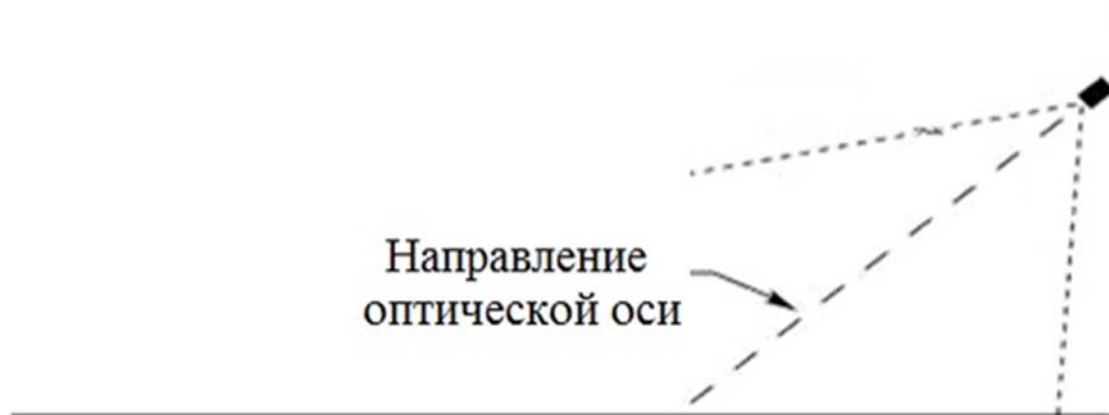
Рис. 4.1. Рекомендуемая установка термокожуха по отношению к горизонту
