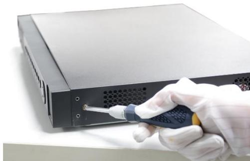
Рис. 2.1. Снятие крышки LTV RTM-040 00
