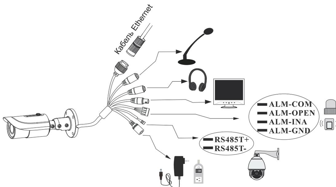
Рис. 3.1.1.2. Подключение кабелей
