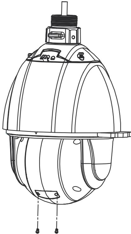
Рис. 3.1.1.1. Снятие защитного купола
