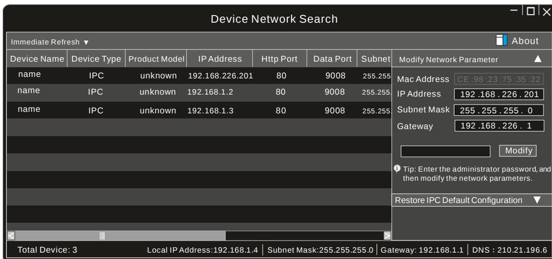
Рис. 5.1.1.1. Интерфейс IP-Tool
