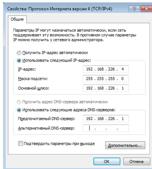
Рис. 5.1.2.2. Настройки IP-протокола
