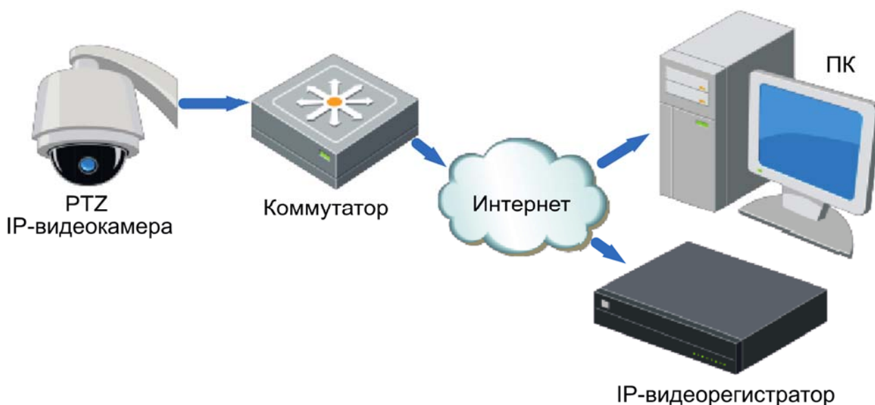
Рис. 3.1. Доступ к IP-видеокамере через локальную сеть
